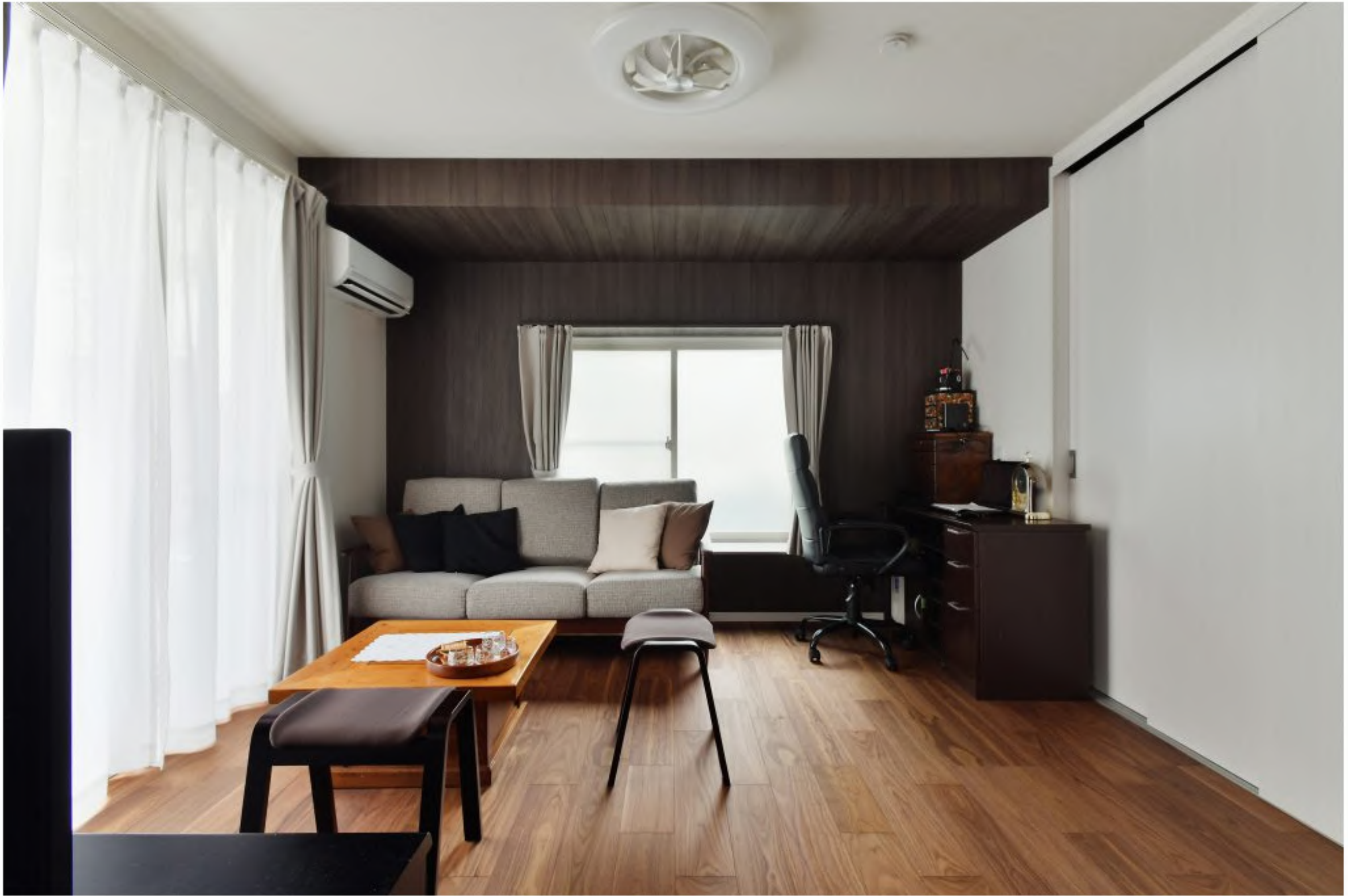
ダイニング：耐震のための大きな梁もあえて下がり天井で隠し、落ち着きのある空間を演出しました
